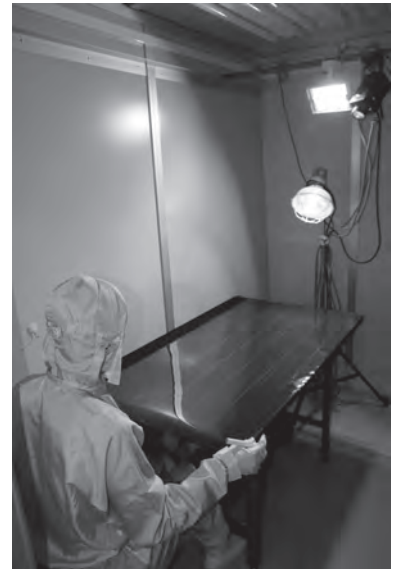
目視による欠点検査の様子。たっぷり時間をかけて行っている
